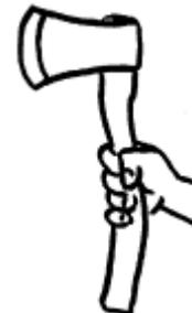
A machada, por poder ser usada apenas com uma mão, deve ser pegada pela «pega», na ponta do cabo, e não a meio do cabo.
