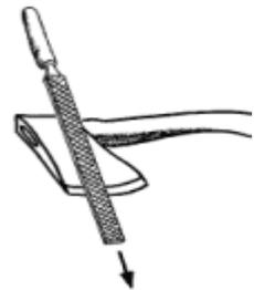
Se a lâmina tiver bocas (ou lâmina romba), deves começar por as fazer desaparecer usando uma lima (de preferência triangular), e só depois usar a pedra de esmeril.
